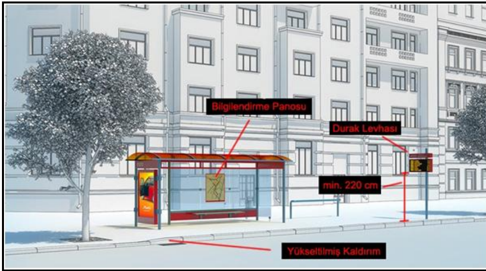
Şekil 21: Herkesin erişim ve kullanımına uygun otobüs durağı tasarım standartları
